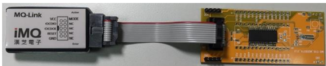
图 2.2 MQ-Link 与 EV Board 连接的示意图 (EV Board 上有产品芯片)
