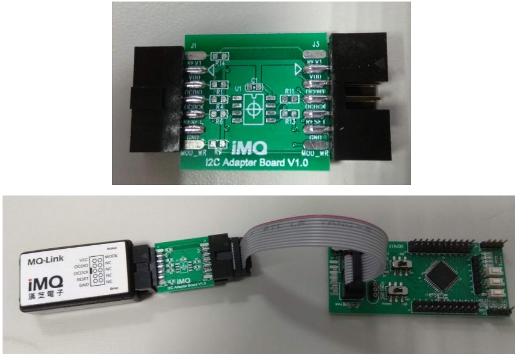
图 5.40 I2C Adaptor Board 與 EVB 连接图
